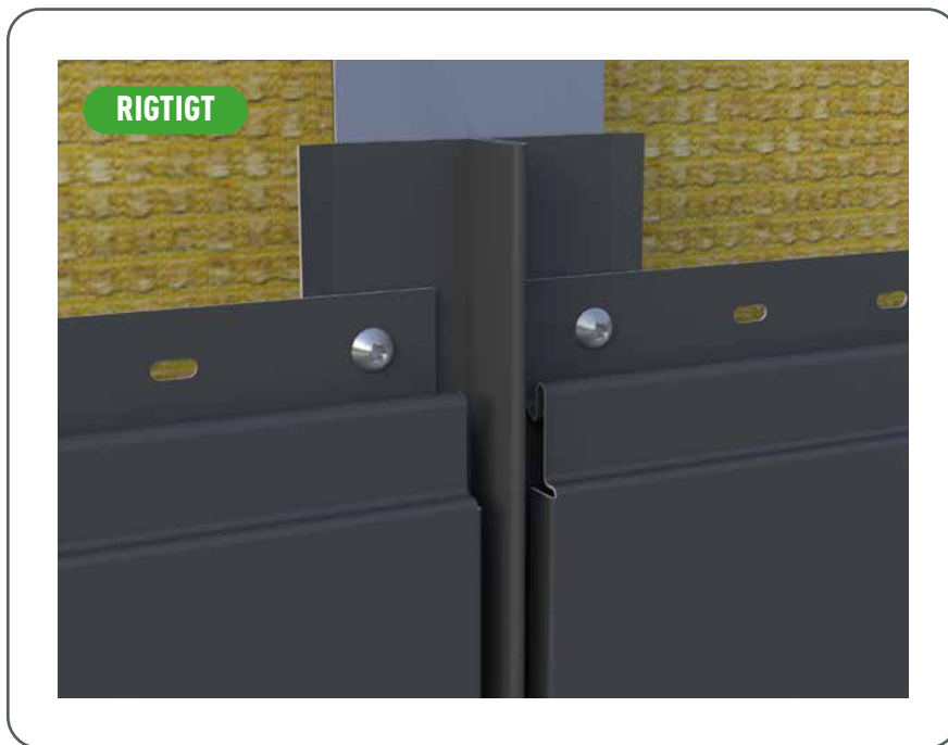
Illustration 91 • Montering med stødplade
