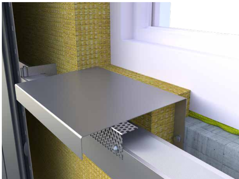
Illustration 93 • Montering af hullet metalplade og holdelister
