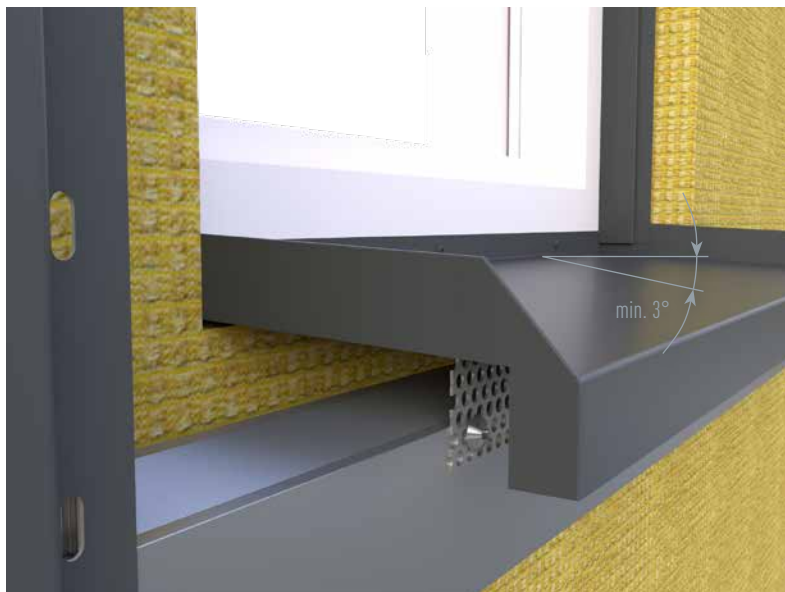
Illustration 95 • Vindueskarm hældning
