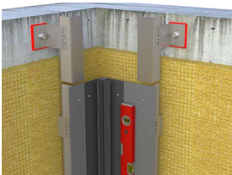
Illustration 82 • Indre hjørne Siding vertikal
