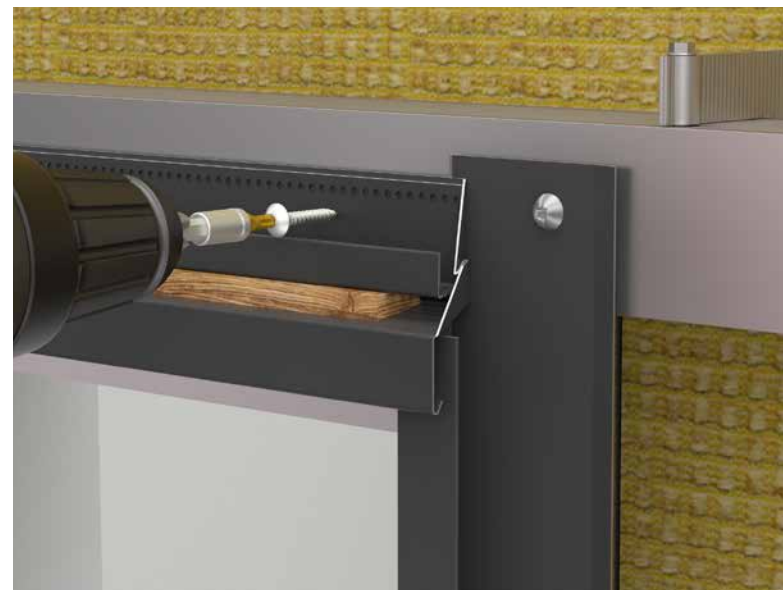
Illustration 102 • Montering af snithulsblænde overkarm
