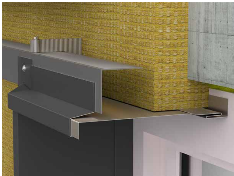
Illustration 101 • Montering af vejrinkelben overkarm
